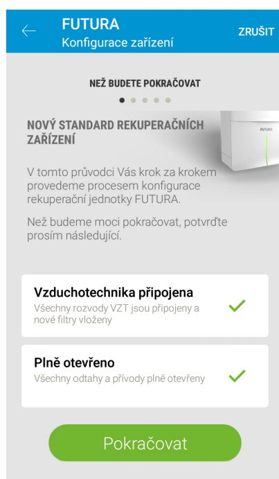
Obrázek 8 – Kontrola připojení vzduchotechniky
