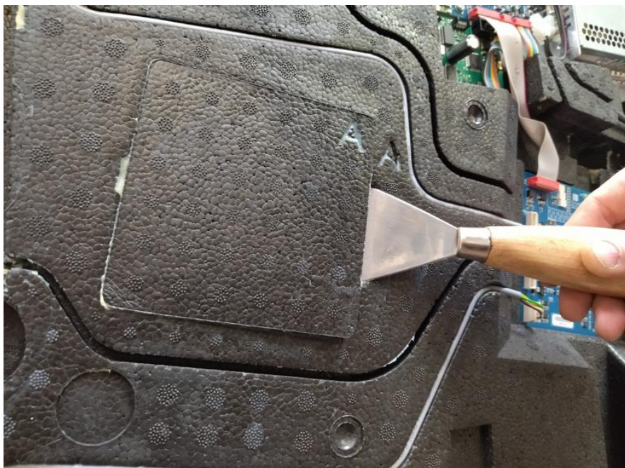
Obrázek 1 - Vyjmutí zátek revizních otvorů
