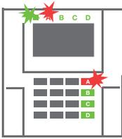
**1. Wenn Sie das Gebäude betreten** (und ein Melder mit einer Reaktion „Verzögerte Zone“ ausgelöst wird), beginnt das System die Eingangsverzögerung zu aktivieren und zeigt dies mit einem Dauerton an, wo eine Eingangsverzögerung ausgelöst wurde. Die Systemanzeige und eine Funktionstaste blinken rot.
