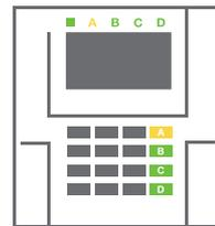
**3. Der Befehl wird ausgeführt** und die Funktionstasten werden dauerhaft gelb, um einen teilweise scharf geschalteten Bereich anzuzeigen.
