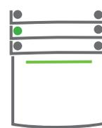
**3. Der Befehl wird ausgeführt** und die Bereichstasten werden grün und zeigen die unscharf geschalteten Bereiche an.
