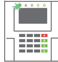
**3. Der Befehl wird ausgeführt** und die Tastatur zeigt akustisch die Ausgangsverzögerung an. Der Bereich ist jetzt scharf geschaltet. Nur Melder mit der Reaktion einer „Verzögerten Zone“ bieten Zeit zum Verlassen des überwachten Bereichs während der Ausgangsverzögerung. Die Statusanzeige und eine Funktionstaste des scharf geschalteten Bereichs werden rot.
