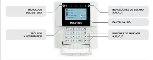
Los estados de cada partición individual son indicados por los indicadores de estado A, B, C, D sobre el display LCD y los botones de función. El panel de control se puede manejar directamente (armar o desarmar la alarma y otras funciones de automatización) utilizando los botones de función del teclado. Los botones de función y los indicadores de estado A, B, C, D están retroiluminados para indicar claramente el estado de la partición.
