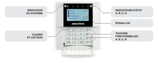
Les états des sections individuelles sont indiqués par les indicateurs d'état A, B, C, D au-dessus de l'affichage LCD et par les touches fonctionnelles. La centrale peut être utilisée directement (armement ou désarmement de l'alarme et des autres fonctions d'automatisation) en utilisant les touches fonctionnelles sur le clavier. Les touches fonctionnelles et les indicateurs d'état A, B, C, D colorés sont rétroéclairés afin d'indiquer clairement l'état de la section.
