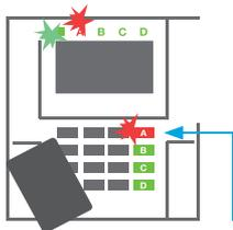
**2. Autorizzazione per se stessi** mediante tastiera – l'indicatore di sistema inizierà a lampeggiare con luce verde.
