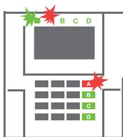
**1. All'entrata nell'edificio** (con innescio di un rilevatore con reazione «zona ritardata»), il sistema si avvia indicando il ritardo entrata, emettendo un suono fisso. Inoltre, l'indicatore di sistema e il pulsante di funzione lampeggiano entrambi con luce rossa (per la sezione in cui l'entrata ritardata è stata innescata).
