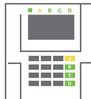
**3. Il comando viene eseguito** e il pulsante di funzione diventa giallo fisso, ad indicare che la sezione è stata parzialmente inserita.
