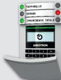
**Quando si disinserisce l'allarme utilizzando i pulsanti del rispettivo segmento**, viene sempre richiesta l'autorizzazione utente. Quando si imposta l'allarme e durante la gestione dei processi automatizzati mediante i pulsanti dei segmenti, l'autorizzazione utente è invece facoltativa per ciascun singolo segmento.
