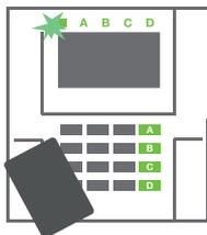
**1. Autorizzazione per se stessi mediante tastiera.** I pulsanti di funzione A, B, C, D delle sezioni per cui si ha l'autorizzazione si accenderanno e l'indicatore di sistema inizierà a lampeggiare con luce verde.
