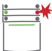
**3. Il disinserimento è completato e le sirene sono tacitate.** Il pulsante verde lampeggiante indica il disinserimento di una sezione concreta. La spia rossa lampeggiante indica memoria allarmi.
