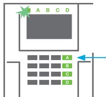
**2. Premere il pulsante di funzione per impostare una sezione particolare.** Si possono impostare anche più sezioni contemporaneamente. L'intervallo di tempo tra la selezione delle sezioni non può superare 2 secondi.
