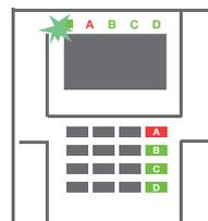
**3. Il comando viene eseguito** e la tastiera indica acusticamente il ritardo uscita. A questo punto la sezione è impostata. Solo i rilevatori con una «zona ritardata» forniscono il tempo necessario per uscire dalla zona protetta durante il tempo di ritardo uscita. L'indicatore di stato e il pulsante funzione della sezione inserita si accenderanno con luce rossa.
