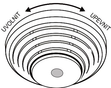
Detektor hlásí nebezpečí požáru. Aktivuje jej výskyt kouře nebo abnormální zvýšení teploty. Kromě odeslání informace do systému zapíná při poplachu akustickou i optickou signalizaci.
