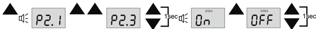
Obrázek 6. Příklad nastavení parametru P2.3 po zapnutí teploměru a nastaveném provozním režimu F2
