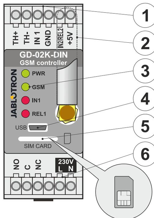
Figura 1: 1 – terminais de baixa tensão; 2 – antena GSM; 3 – indicadores LED; 4 – conector MicroUSB para ligação ao PC; 5 – ranhura do cartão SIM; 6 – terminais do relé de potência e terminais da rede elétrica de 230 V.
