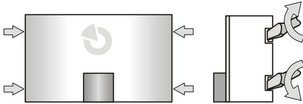
1. Aprire la copertura dell'indicatore allentando le quattro linguette, ruotandole nella direzione indicata dalle frecce, utilizzando un cacciavite idoneo.
