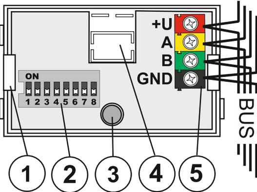
Figura: 1 – linguetta pannello; 2 – interruttore di configurazione; 3 – LED indicatore rosso; 4 – apertura a pressione; 5 – morsetti bus
