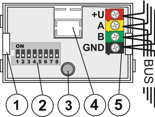
Рисунок: 1 – зажим панели; 2 – переключатели настройки; 3 – красный индикатор LED; 4 – отверстие для кабеля; 5 – терминалы шины
