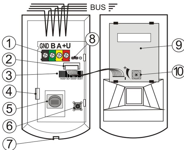
Figure 1 - Bornes du bus; 2 - Connecteur micro-ondes; 3 - Code de production; 4 - Languette du circuit; 5 - Capteur PIR; 6 - Contact de sabotage; 7 - Languette du capot; 8 - Cavalier de test; 9 - Capteur MW; 10 - Paramétrage de la sensibilité MW;
