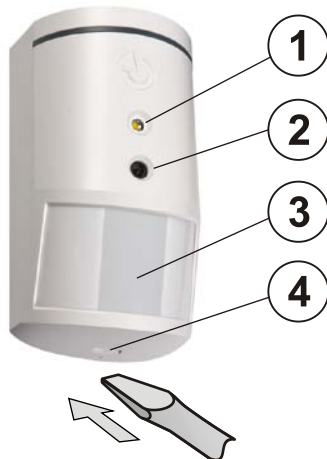
1. ábra: 1 – villanófény; 2 – a fényképezőgép objektívje; 3 – a PIR mozgásérzékelő lencséje; 4 – az érzékelő fedelének rögzítő nyelve;
