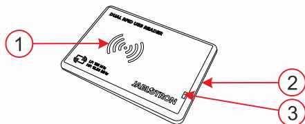
Bild. 1: 1 - LF-, HF-antenn, 2 - USB-port B mini, 3 - LED-signalering
