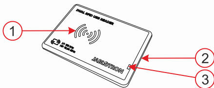
Рис. 1: 1 - НЧ, ВЧ антена, 2 - USB порт B mini, 3 - світлодіодна сигналізація
